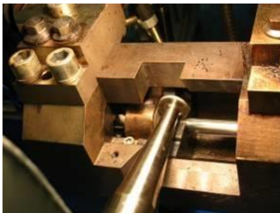
Рис. 5.2. Вращающийся волновод ультразвуковой сварки фольги
